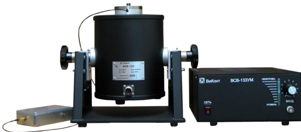
Рисунок 1 – Общий внешний вид виброустановки электродинамической ВСВ-133
