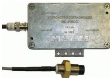
Вихретоковый преобразователь перемещений.
