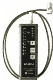
Прибор "ВАДИМ" предназначен для диагностики межвальльных и других подшипников качения на авиационных двигателях, газотурбинных установках или других машинах при ручной прокрутке их роторов.
